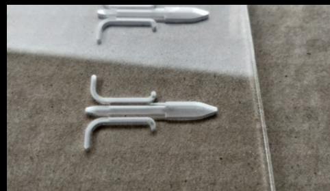
Prototeip o sglodyn microhylifeg a gynhyrwyd trwy defnyddio technegau micro-felino. Delwedd: FPC@DCU
